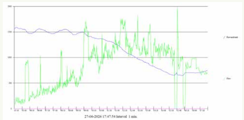
Datalog fra Kattrup Vandværk, lørdag 26. juni. Intervallerne viser, hvornår der blev brugt markant mere vand. Hen på eftermiddagen var beholdningen i rentvandstanken helt i bund.
