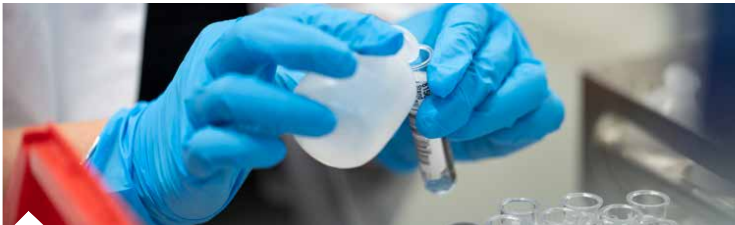
Vandprøven omhældes til mindre glas, hvor der tilsættes reagenser, der er nødvendige for at bestemme specifikke pesticider i vandet.
