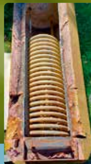
Kalkknuser-behandlet varmtvandsbeholder fra Langeland. (21 °dH).
