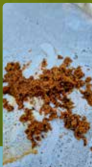
Ubehandlet varmtvandsbeholder fra Lejre. (17 °dH).
