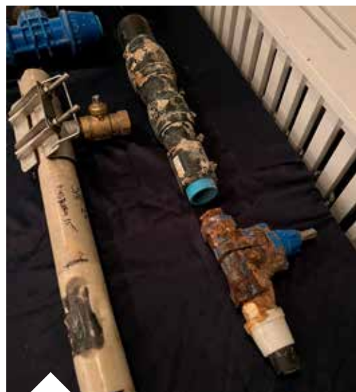
Defekte stophaner, stikledninger og vandrør, som vandforsyningens personale graver op og skifter ud. Forbrugere kunne få en forklaring på komponenternes funktion.
