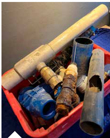
Defekte stophaner, stikledninger og vandrør, som vandforsyningens personale graver op og skifter ud. Forbrugere kunne få en forklaring på komponenternes funktion.
