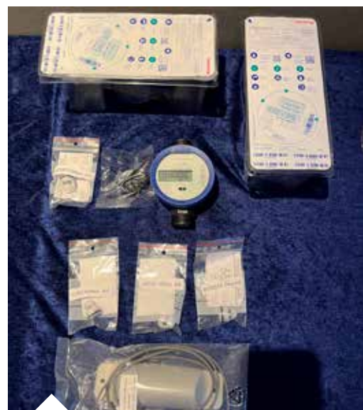
Her ses den elektroniske vandmåler, som installeres hos forbrugerne.
