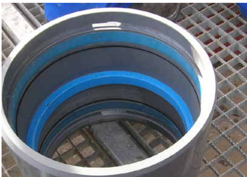
▲ Muffe med centerstop, limflade, o-ring, hydrotitebånd og udfræsning til låsebånd.
