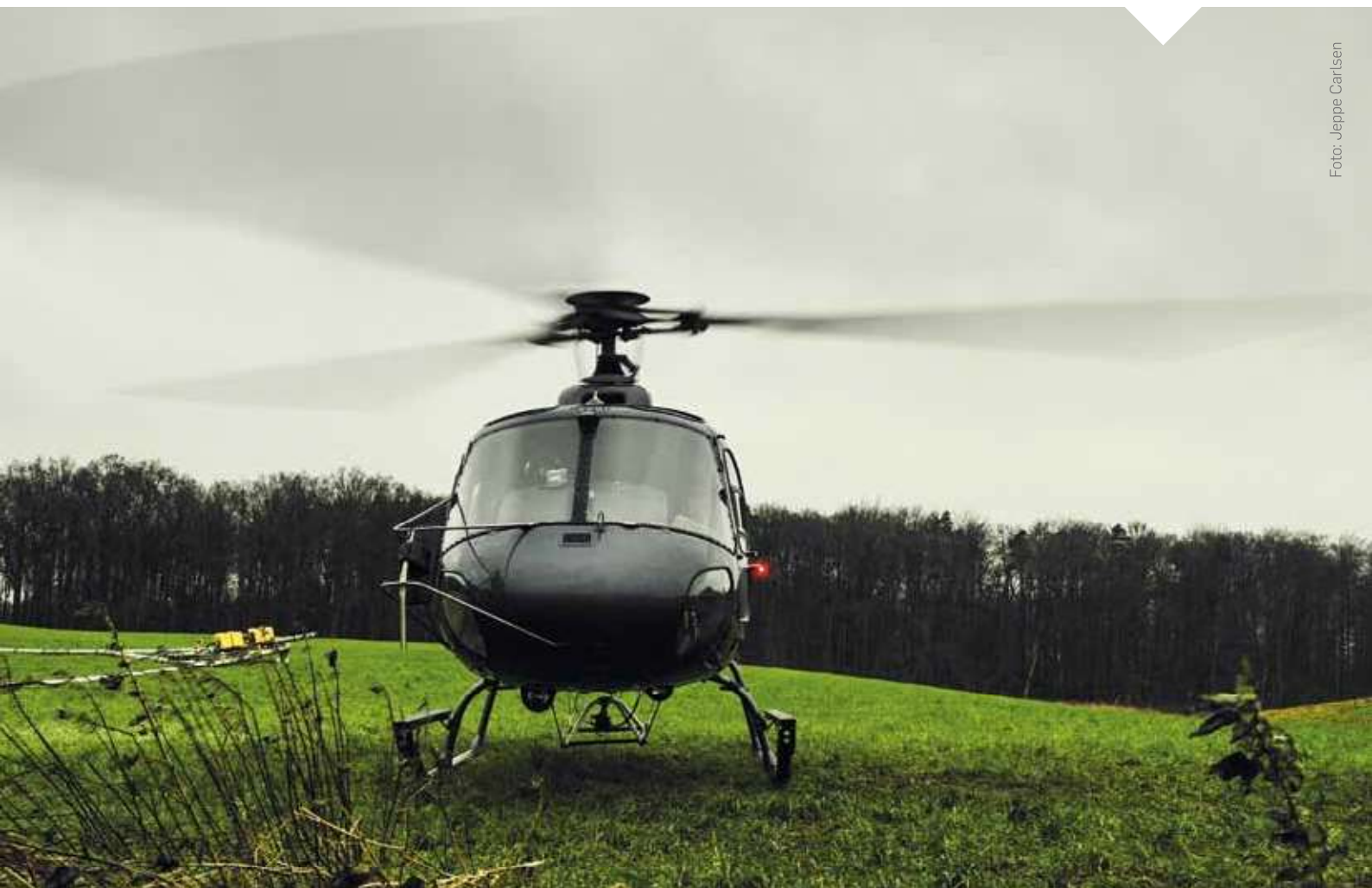
SkyTEMs helikopter indsamler informationer til at kortlægge grundvandet.
